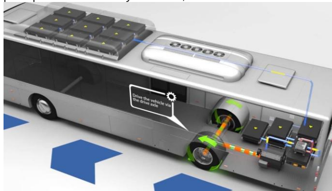
Figuur 1 Typisch principe van een volledig elektrische bus, met de batterijen op het dak en een motor achterin de bus voor het omzetten van de elektrische energie naar kinetische energie ( www.youtube.com ).
