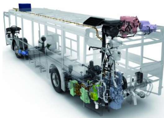
Figuur 2 Typisch principe van een hybride bus, met de traditionele brandstofmotor achterin de bus en de brandstoftanks tussen de achterwielen ( bron ). Ook hier bevinden de batterijen zich op het dak.
