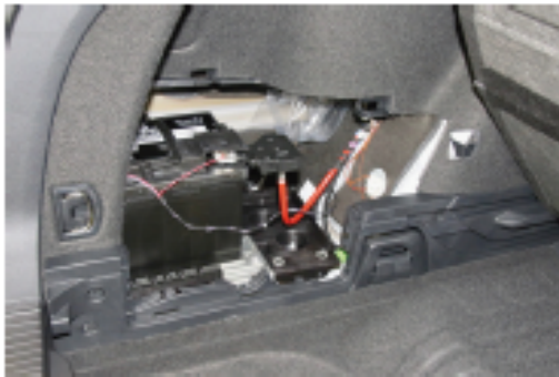
Bild 4 Verbaute Hauptbatterie im Kofferraum eines Pkw unter der Verkleidung
