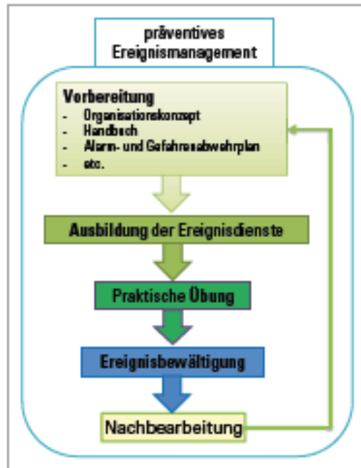
Bild 1 Stufen und Arbeitsschritte des präventiven Ereignismanagements
