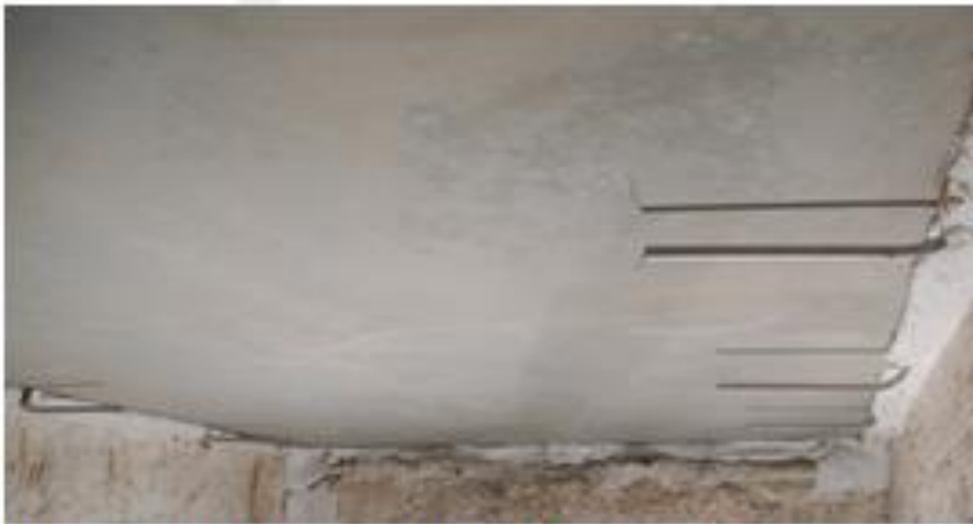
Figuur 5: afspatgevoelig beton. Links voor brandproef, rechts na brandproef
