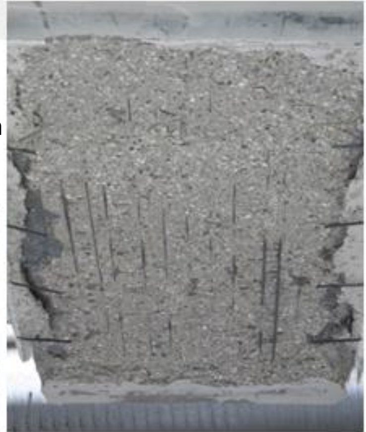
Figuur 5: afspatgevoelig beton. Links voor brandproef, rechts na brandproef
